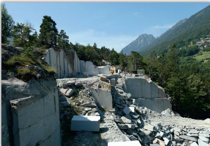
1) Bei Martigny wird der Vert de Salvan gewonnen: rechts unten der «Bruch», oben links die frische Abbau-Wand, im Vordergrund zwei fertige Blöcke zum Verlad.
